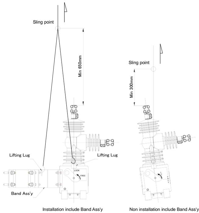
Figura 4-2. Elevación de Reconectador (Una Fase)
